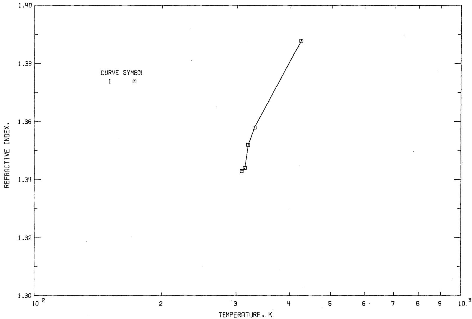
FIGURE 23. REFRACTIVE INDEX OF MAGNESIUM FLUORIDE (TEMPERATURE DEPENDENCE).
