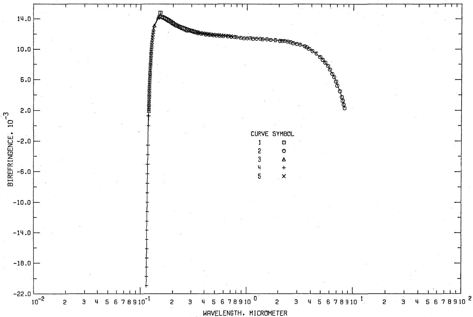
FIGURE 25. BIREFRINGENCE OF MAGNESIUM FLUORIDE (WAVELENGTH DEPENDENCE)
