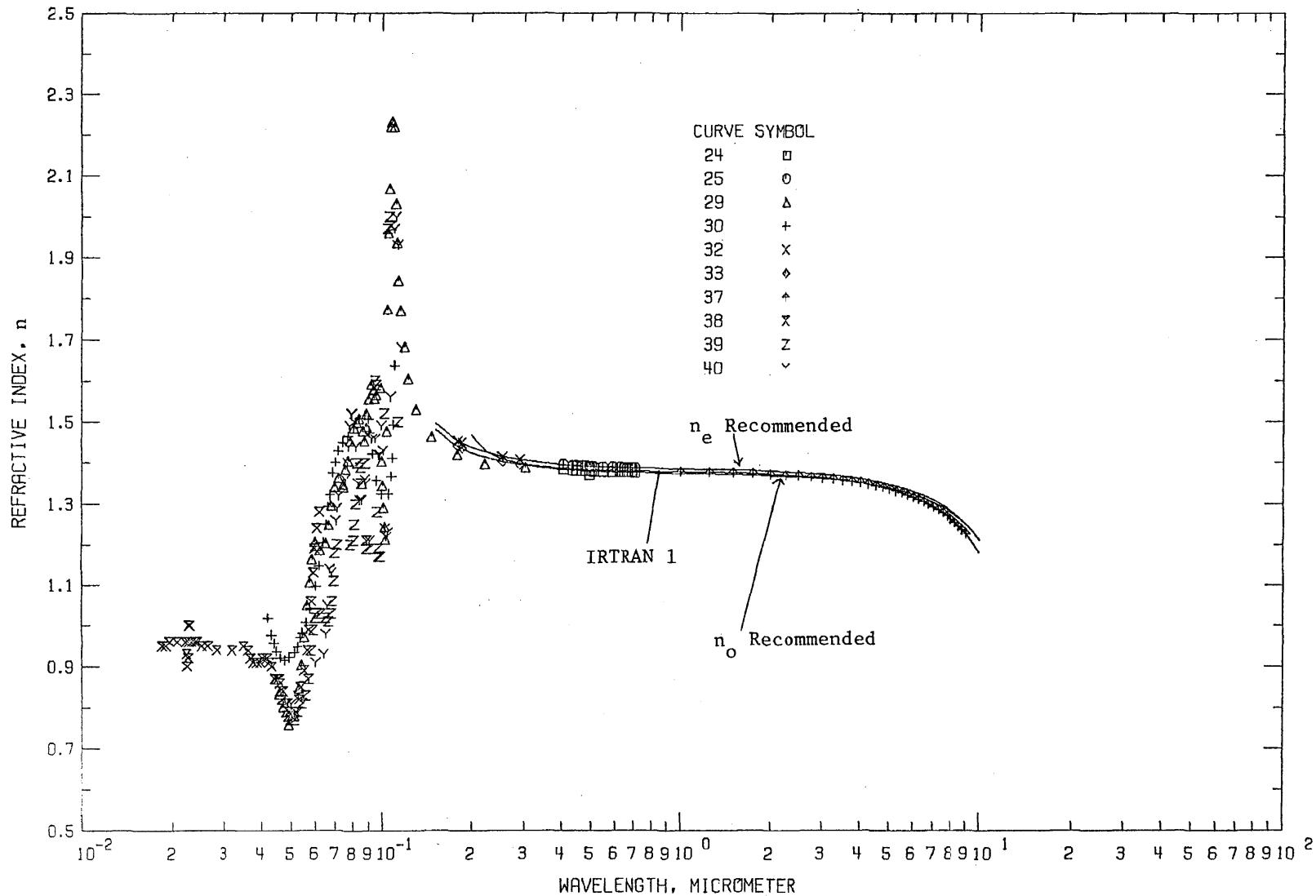
FIGURE 21. REFRACTIVE INDEX OF MAGNESIUM FLUORIDE (WAVELENGTH DEPENDENCE).
