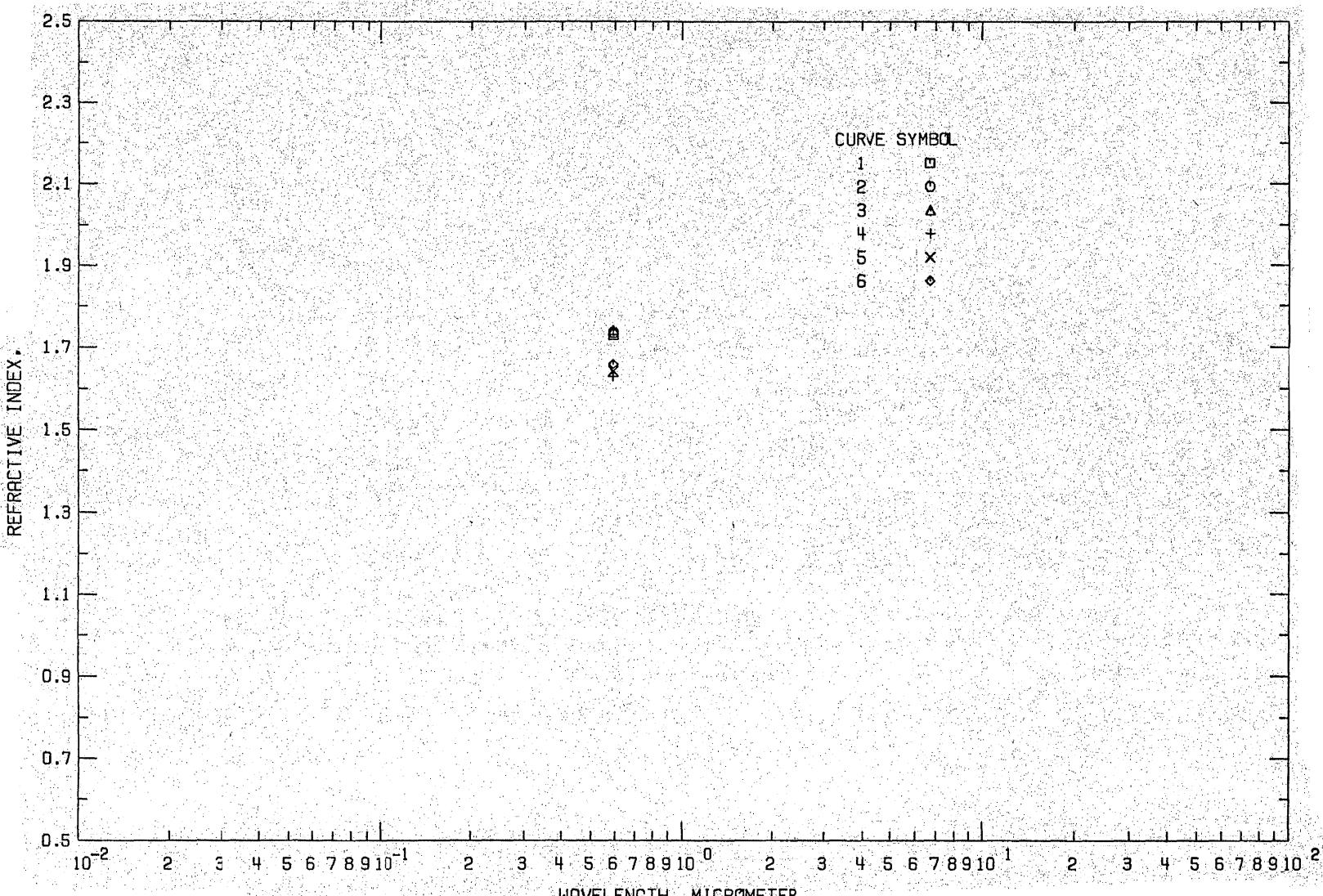
FIGURE 28. REFRACTIVE INDEX OF BARIUM CHLORIDE (WAVELENGTH DEPENDENCE).
