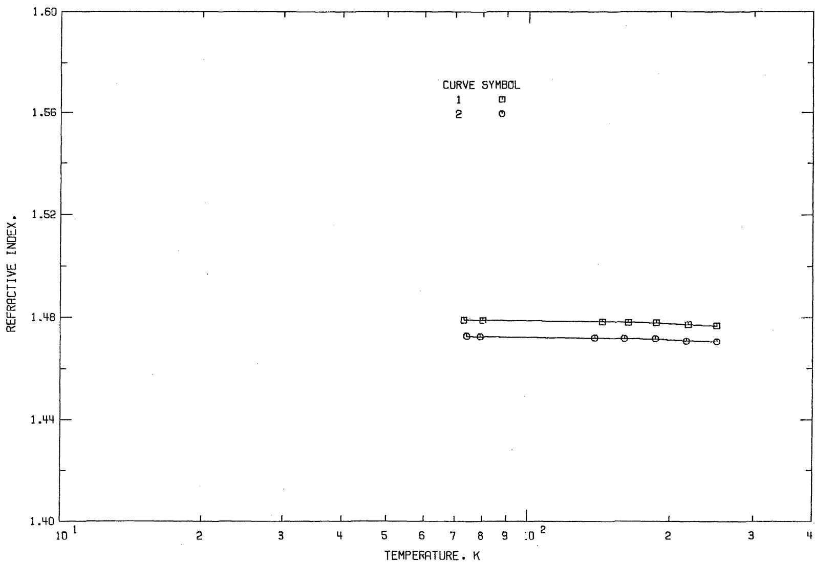
FIGURE 18. REFRACTIVE INDEX OF BARIUM FLUORIDE (TEMPERATURE DEPENDENCE).
